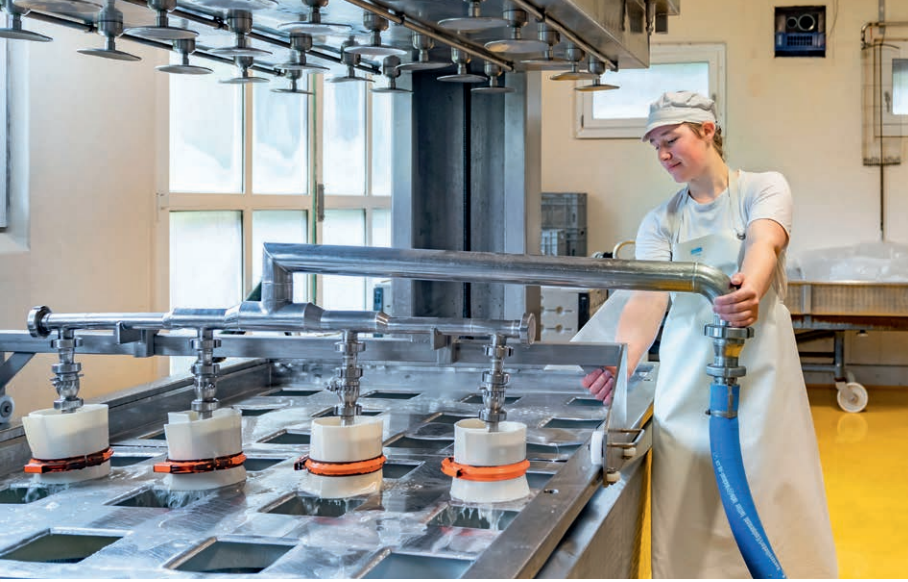
◀ Die Milchtechnologin füllt den Käsebruch in Formen, damit er gepresst werden kann.
